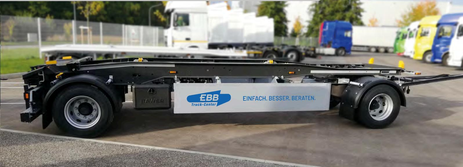
Hoch beanspruchte Container mit verschlissenen oder blockierten Rollen lassen sich mit dem EBB AS in der Schlittenversion einfach und schnell aufnehmen und absetzen. Dazu bietet die gewichtsoptimierte Fahrzeugvariante 400 kg mehr Nutzlast.
