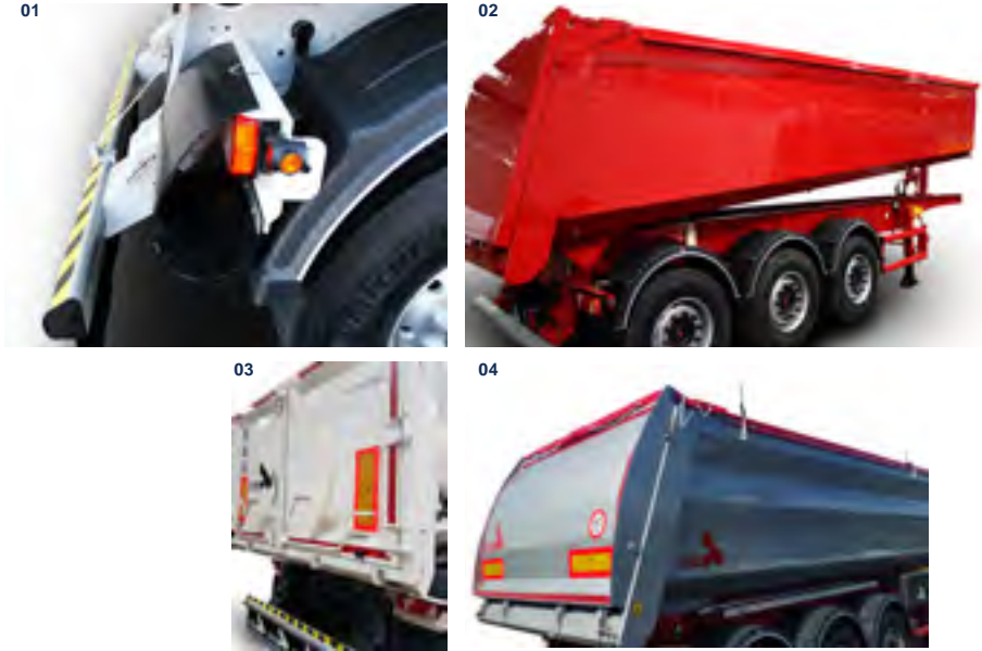
01 Spritzgummi am Leuchtenhalter befestigt (Strassenfertiger) 02 Isolation der Aufbau 03 Getreideschieber hexagonal 04 hydraulische Pendelklappe
