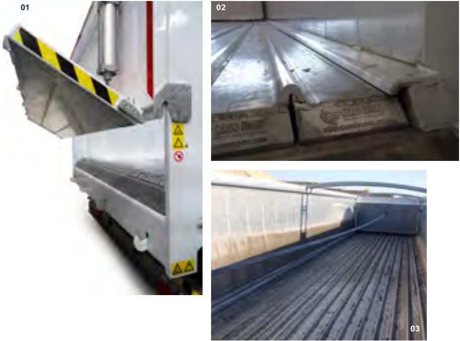
01 zweiteilige pneumatische Hecktür 02 Boden HD SEALLESS 03 hydraulische Restlosentleerungswand
