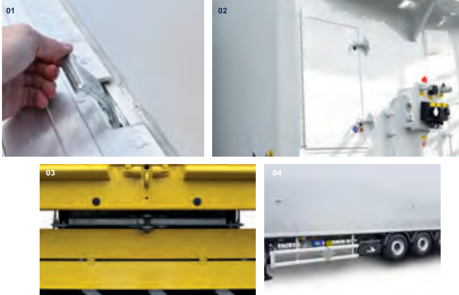
01 Zurrösen 02 Service-Tür im Stirnwand 03 Abschlepphaken 04 Konsole vor den Achsen
