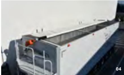
01 Getreideschieber 02 Sichtfenster in der Seitenwand 03 integrierter Trichter 04 automatische Plane
