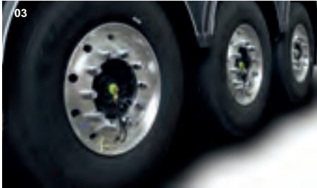
01 Carapax Plane 02 doppelter Ersatzradhalter 03 Reifenbeifüllsystem 04 Alu Leiter am Fahrgestell
