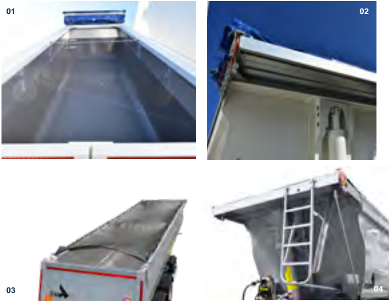
01 Kunststoff Bekleidung Seitenwand und Boden 02 Cramaro 03 Cramaro Netz 04 Leiter am Stirnwand
