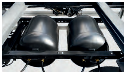
Luftbehälter für Bremsen und Pneumatiksysteme.
