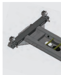
Befestigungsart von 40'HC-Containern.
