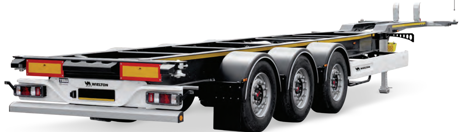
Konfiguration für 1x45'-Container.
