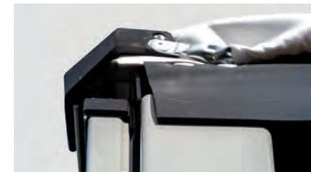
Abgeschrägte obere Ecke zur Vermeidung von Kollisionen beim Drehen des Aufbaus.
