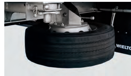
Ersatzrad mit Ersatzradwinde
