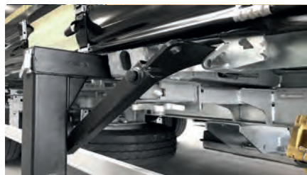
Stützfuß in ausgestreckter und gesicherter Position
