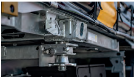
Verriegelungsmechanismus für den Stützfuß des Containers mit Zugang von außen
