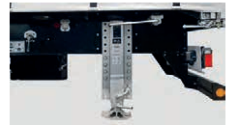
Stützfüße zur Sicherung der Last
