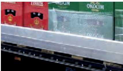
Leiste zur Sicherung der transportierten Getränke
