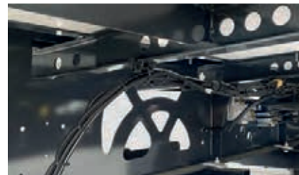
Gewichtsoptimierte Heckkonstruktion des Aufliegers
