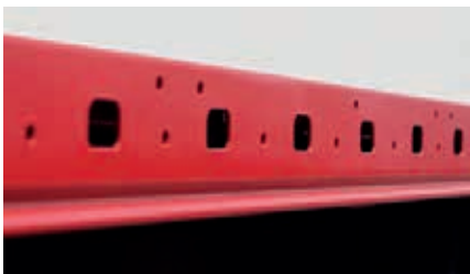
Ladungshalteösen im Rahmenflansch
