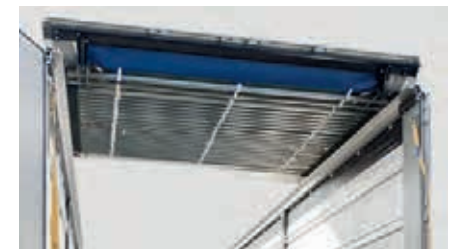
Schiebeverdeck zum einfachen Beladen
