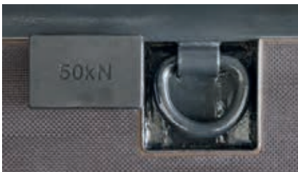
Befestigungsöse im Boden (Coil Master)
