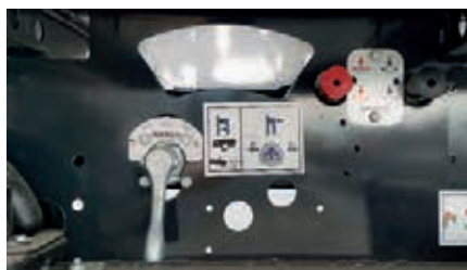
Steuerblock für Pneumatik
