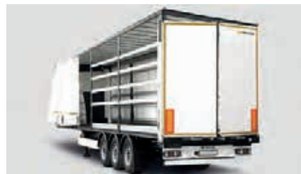
Das Dach kann einseitig angehoben werden
