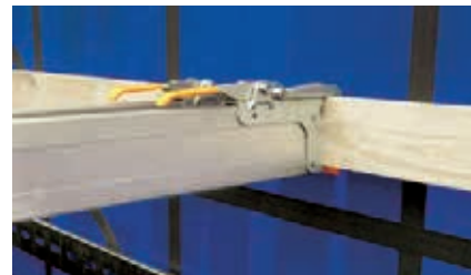
Sperrbalken der Ladungssicherung (Basis)
