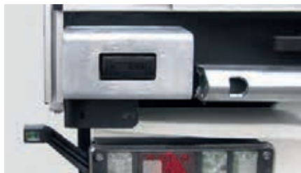
Rückwärtsfahrsensor im hinteren Rampenpuffer
