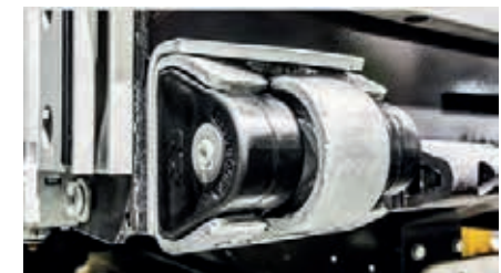
Rampenanfahrrolle kann montiert werden
