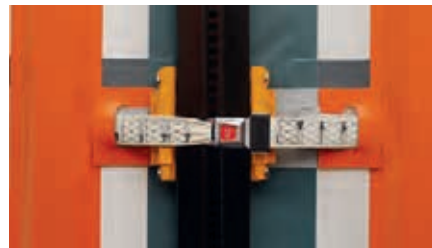
Zwischenlagen an den Seitenpfosten im XLS-System
