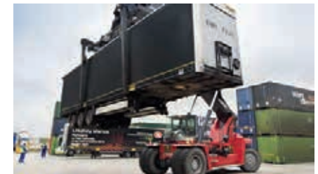
Verladung eines Aufliegers auf einen Eisenbahnwagen
