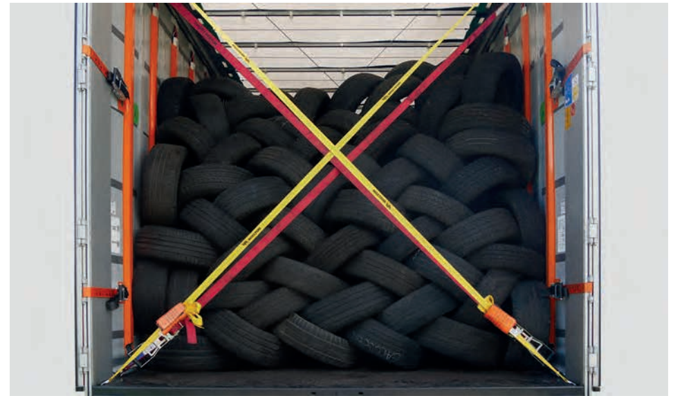
Konfiguration der Einstecklatten für den Reifentransport
