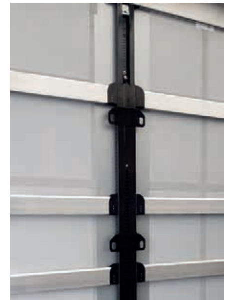
Ösen zur Sicherung der Ladung auf den Rungen
