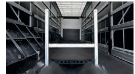
Pfosten zur Sicherung der Stahlspulen
