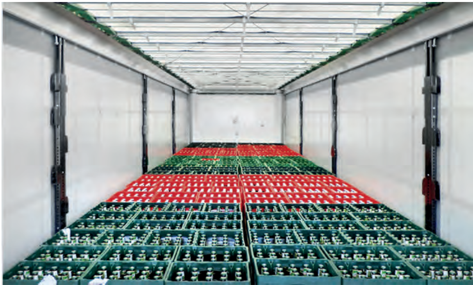
Leiste zur Sicherung der transportierten Getränke
