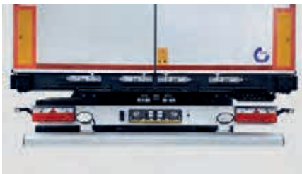
Aluminium-Unterfahrschutz zur Gewichtsreduzierung
