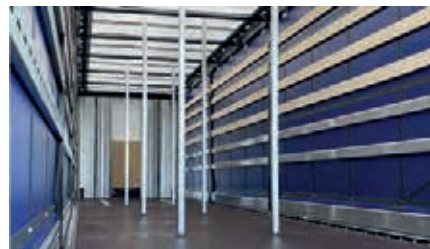
Vertikale Pfosten in Verstauen Position
