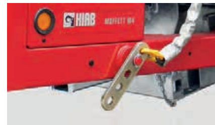
Sicherung des Gabelstaplers während des Transports
