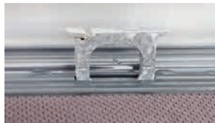
Befestigungsöse im Boden
