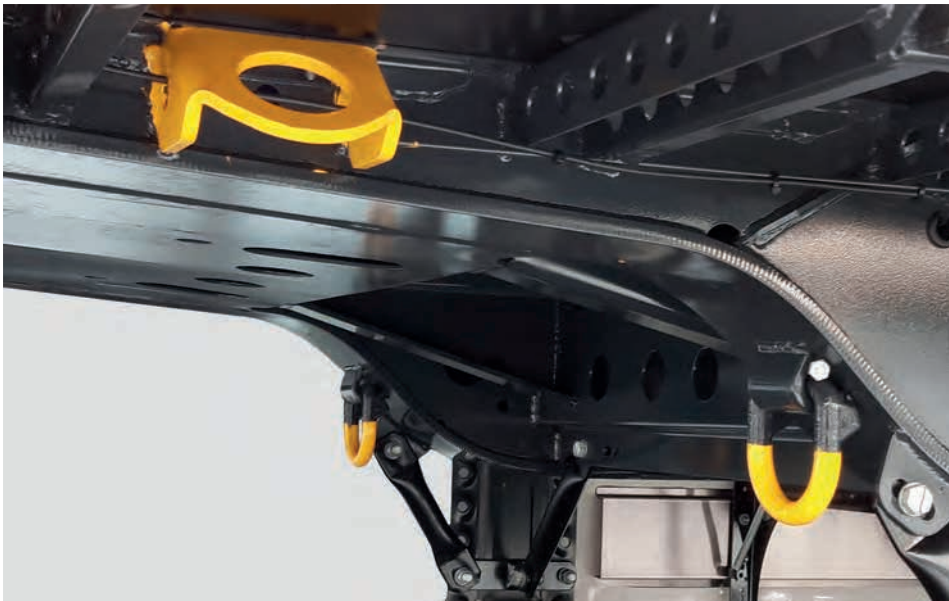
Fährenlaschen befinden sich an der Vorderseite des Aufliegers
