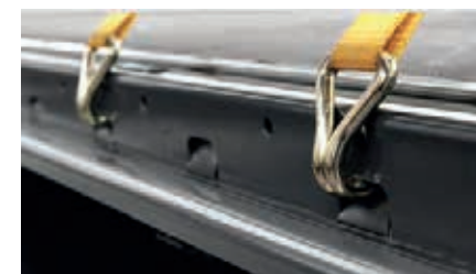
Safety-Lock-Leiste zur Sicherung der Ladung
