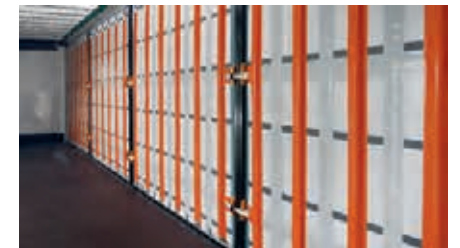
Ansicht der Aluplank-Plane mit dem XLS-System
