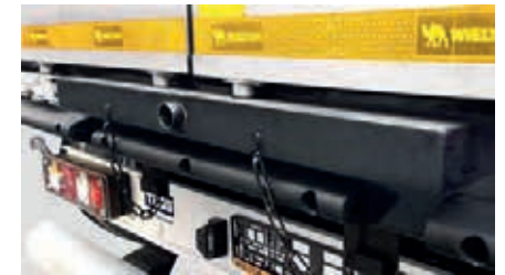
Diebstahlschutzleiste zum Schutz der Riegel
