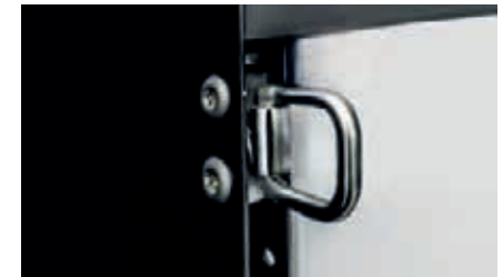
Ösen zur Sicherung der Ladung auf den Rungen
