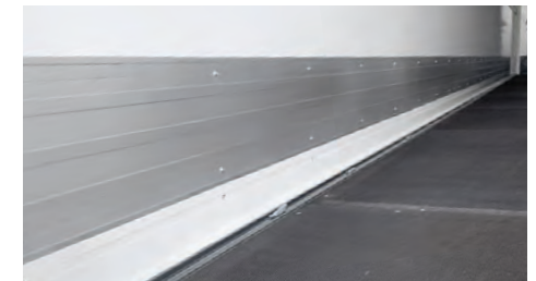
Aluminiumprofile zum Schutz der Seitenwände.
