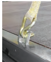
In den Boden eingelassene Ladungssicherungsösen.
