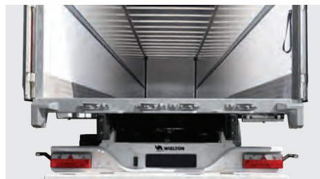
Hintere Rampenpuffer aus Stahl.
