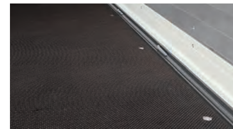
Der Boden des Kofferaufliegers, 30mm wasserdichte, hochfeste Siebdruckplatte. Zulässige Gabelstaplerlast 7,5 t.
