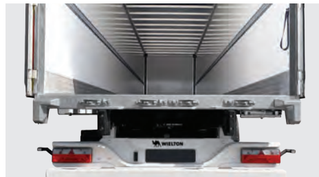
Hintere Rampenpuffer aus Stahl.
