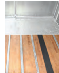
Hintere Ladekante aus Stahl, 700mm.
