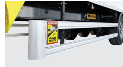
Seitlicher Unterfahrschutz aus Aluminium.
