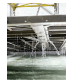
Die Abmessungen unserer Arbeitsstationen ermöglichen es, den Rahmen eines Aufliegers vollständig bei dem kataphoretischen Lackierprozess einzutauchen.
