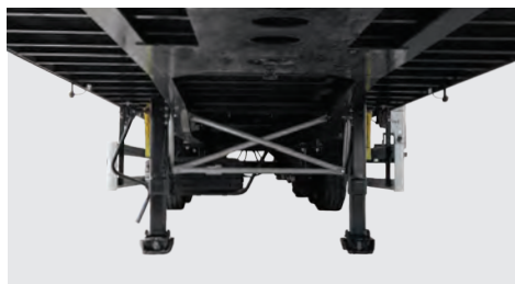
Rahmen in hochfestem S700- Leichtbau-Stahl.
