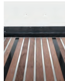
Verstärkter Boden 10t, Kerug Holz.
