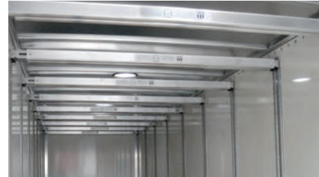
Schlüssellochleisten für Transport hängender Kleidung auf Stangen.
