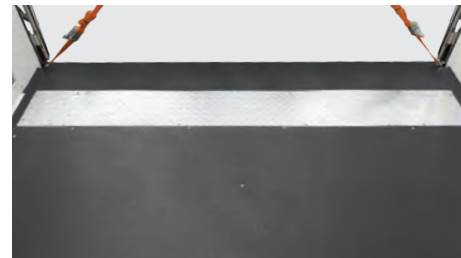
Verstärkung der hinteren Ladekante im Boden.
