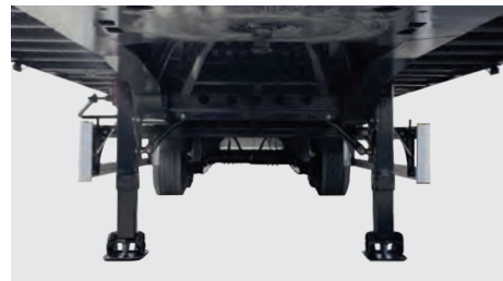
Ein solider und leichter Rahmen aus Stahl S700 und S355.
