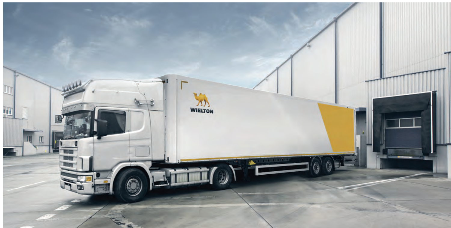
Seitlicher Unterfahrschutz, gefertigt aus Aluminium.
