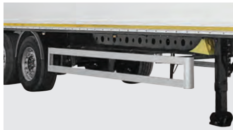
Seitlicher Unterfahrschutz, gefertigt aus Aluminium.
