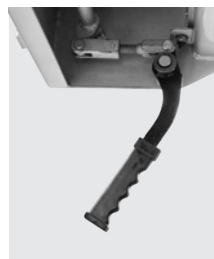
Sicheres Türöffnungssystem an der Seite des Auflegers.
