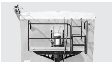
Gewichtsoptimierte Arbeitsplattform mit Klappleiter
