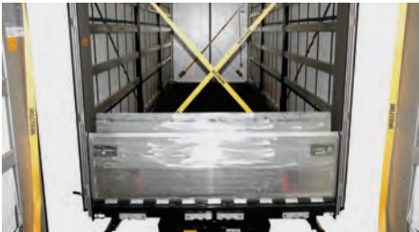
Der Lampenträger ist aus leichten und beständigen Verbundstoffen gefertigt.
