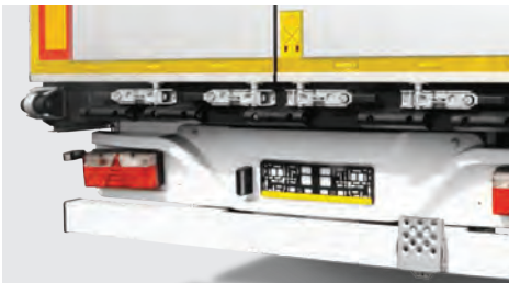
Der Lampenträger ist aus leichten und beständigen Verbundstoffen gefertigt.
