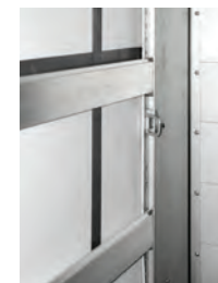
Lattentaschen und Zurrösen in der vorderen Eckrunge.
