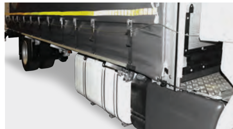
Kraftstoff- und AdBlue-Tank.
