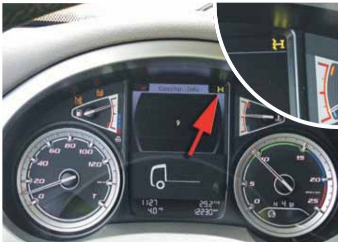
Ein simpler Kippschalter aktiviert PXP, thematisch richtig liegt er gleich neben der Diff-Sperre. Ein gelb leuchtendes Symbol meldet: „PXP aktiv“, über 20 km/h blinkt die Anzeige für „PXP in Stand-By“.
