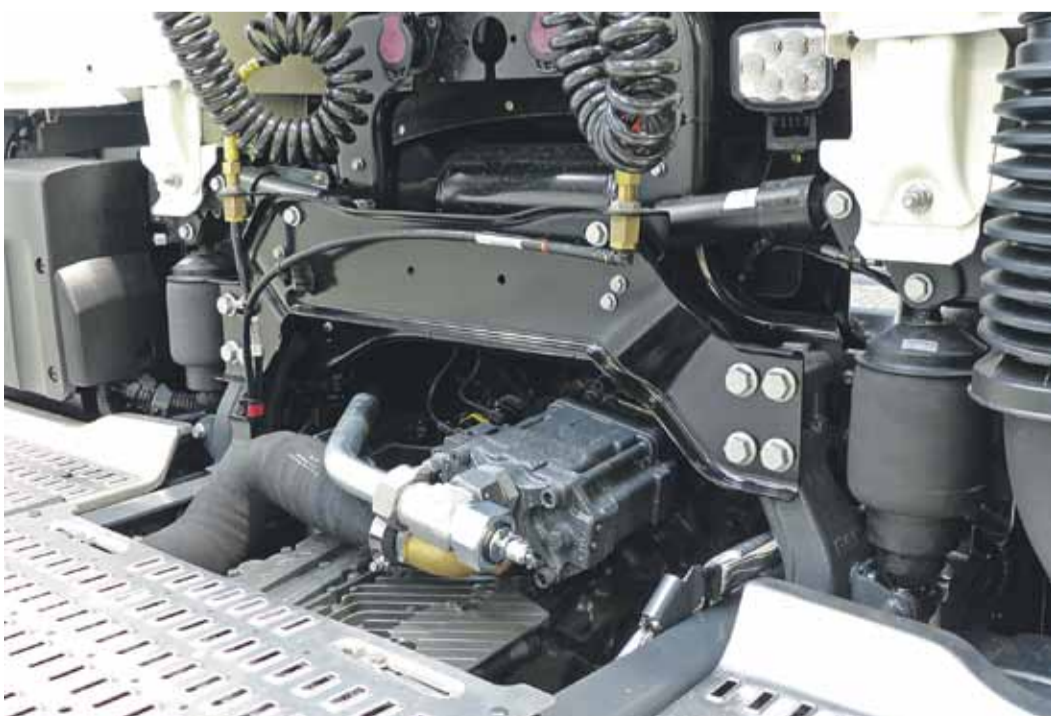
Kraftquelle: LS-Hydraulikpumpe für den Antrieb am motorseitigen Nebenabtrieb. Eine gleichzeitige Versorgung der Kipp hydraulik mit ein und demselben Öl vorrat schied für Paul aus. Die Gefahr von Verunreinigungen und Spänen sei für die Radnaben-Motoren zu groß.
