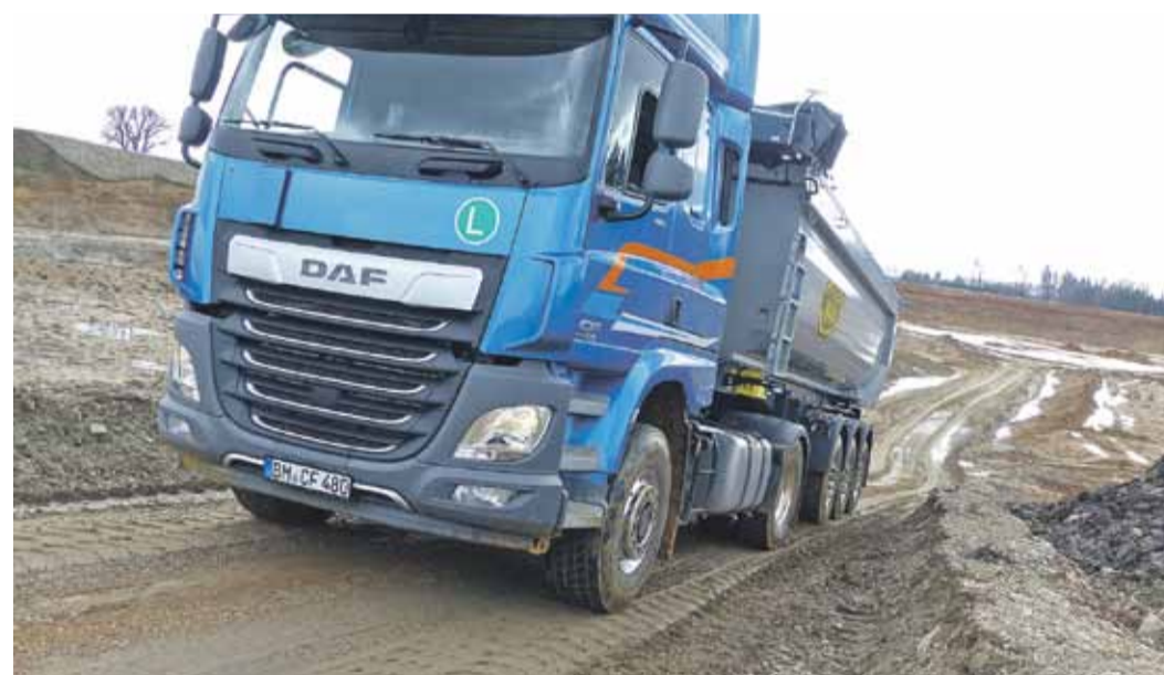
Anfahren in der Steigung, beladen: Der Profilabdruck verrät, dass hier nichts durchdreht, sondern die Vorderachse zieht.
