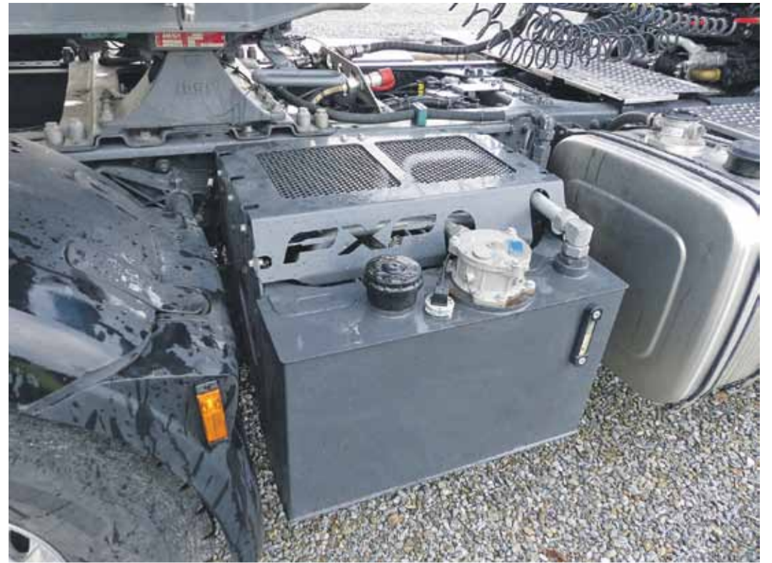
Kompakte Einheit: Das PXP-Modul enthält den kompletten Hydraulik-Block, den Kühler und den 55-Liter-Ölvorrat. Rechts daneben der Öltank für die unabhängig arbeitende Kipp-Hydraulik.
