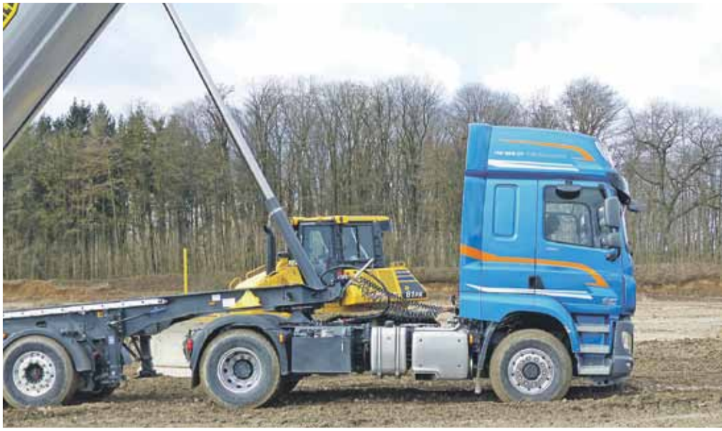
Hier rettet PXP und nicht die Raupe: Nach Abkippen zu wenig Last auf der Antriebsachse, nach Zuschaltung PXP kommt die Fuhrer von selbst wieder in Schwung (vgl. auch Video auf Transport-Online)
