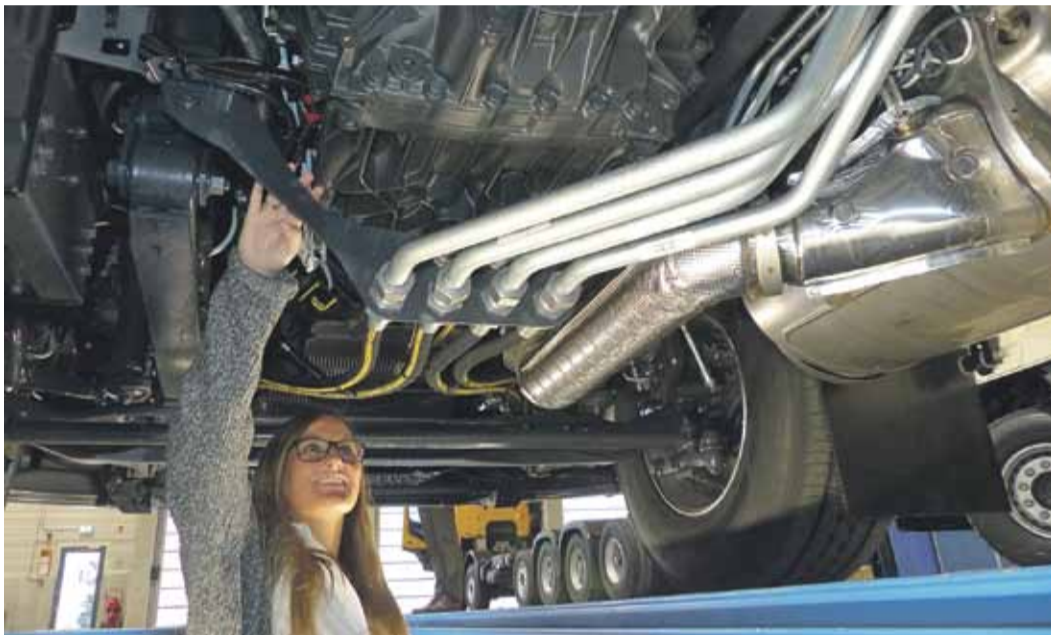
Katja Oberhuber, Teamleiterin Entwicklung und Konstruktion bei Paul, zeigt die sehr aufgeräumte und solide Verlegung aller Leitungen. Zwischen Haltebügel und Getriebe ist noch Luft für weitere Getriebe-Typen.
