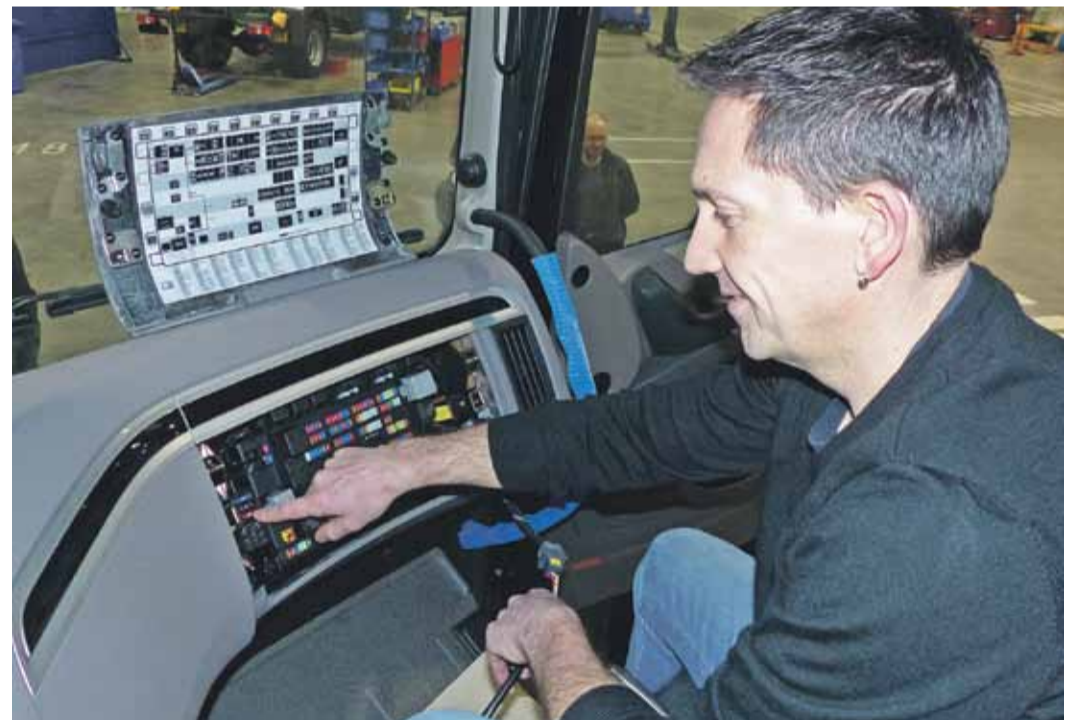
Elektronik-Chef Nikolaus Mayer zeigt: Alle Sicherungen und Relais sind in der DAF-Zentralelektrik integriert.
