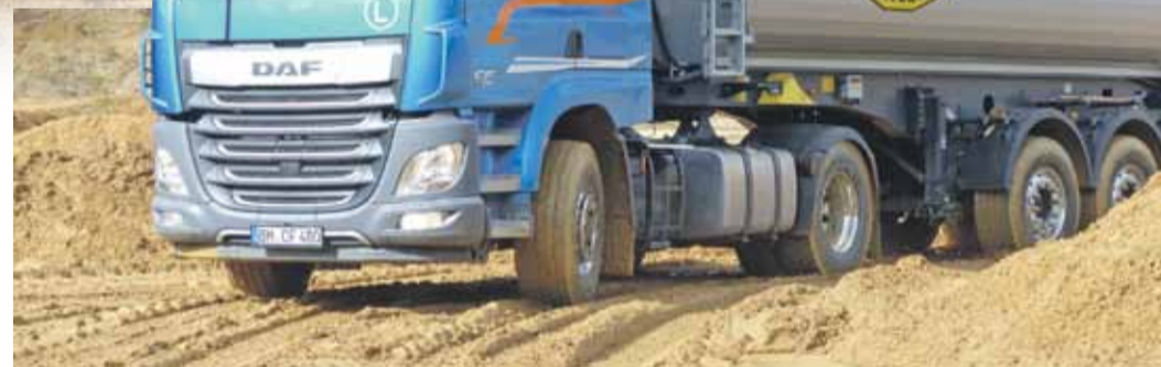
Gerade in Kurven, wenn der Fahrwiderstand steigt, ist die angetriebene Vorderachse eine große Hilfe.
