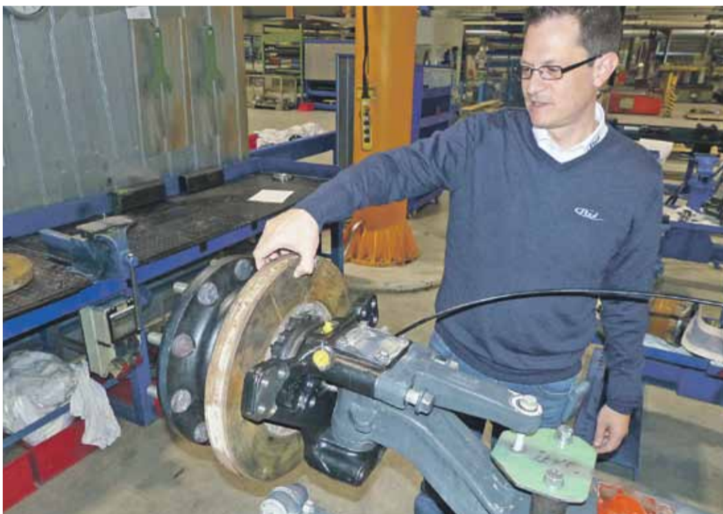
Andreas Süß ist als Leiter der Entwicklung bei Paul stolz auf den hohen Grad an Standard- und Gleichteilen. Wie hier die Original-Bremsscheibe, die wieder im neuen Achskopf eingebaut wird.
