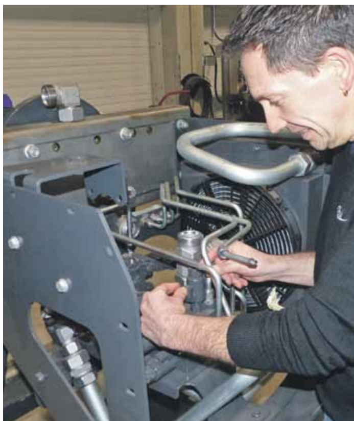
Nikolaus Mayer, bei Paul für Elektrik und Elektronik zuständig, zeigt uns das Steuerventil.
